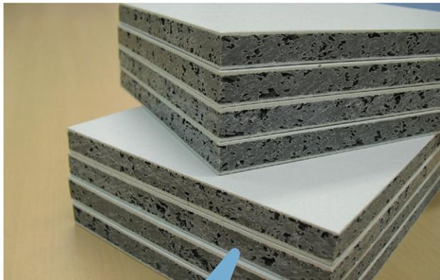
ボード断面（三層発泡構造）
